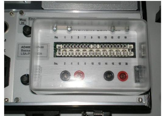
Der Basisadapter ist die Schaltzentrale für alle anderen Adapter. Er enthält einen Steckereinsatz zum Testen von LSA-Plus-Magazinen und zusätzlich zwei Positionen zum Prüfen einzelner Gasentladungsableiter, die hier mit den Adaptersteckern für die Bauformen F, G, H und E belegt sind.
