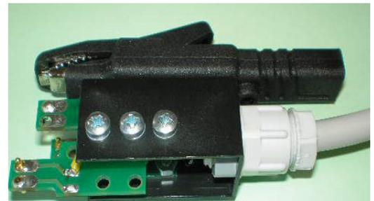
Den Prüfadapter in die Hand nehmen, dabei die angebaute Krokodilklemme öffnen, die hervorstehende Leiterplatte (grün) in die rechteckige Öffnung führen und gleichzeitig die Krokodilklemme über den Kragen am Flansch führen.
