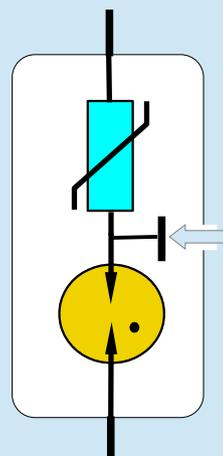
Bei Einsatz des Schutzes vor dem Zähler verlangen die Stromversorgungsunternehmen, dass ein etwaiger Leckstrom des Varistors abgeschaltet wird. Das macht der Gasentladungsableiter.
