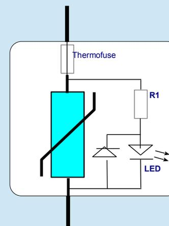
Manchmal ist ein ohmscher Widerstand parallel zum Varistor geschaltet – z.B. für eine Statusanzeige mit LED.
