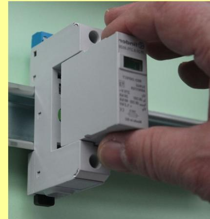
Oft werden hier als Schutzelemente Varistoren eingesetzt, die haben aber die unangenehme Eigenschaft, dass ihr Leckstrom infolge häufiger Belastung stark ansteigt und die Netzspannung den Varistor erhitzt bis hin zur ernststen **Brandgefahr**.
